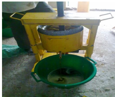
Prensado de la semilla con prensa manual
